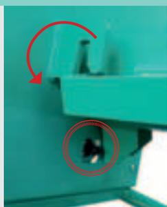
Sensore di sicurezza di blocco elettrico automatico in caso di smontaggio della camera di miscelazione.
