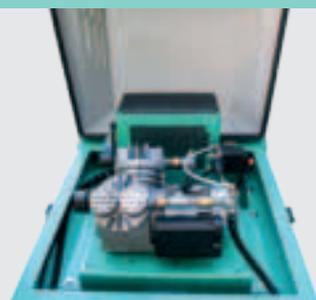
Compressore IM250 integrato nella macchina e protetto dalla cappotta, facilmente accessibile per la manutenzione dei filtri aria.
