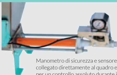
Manometro di sicurezza e sensore di pressione collegato direttamente al quadro elettrico per un controllo assoluto durante il lavoro.
