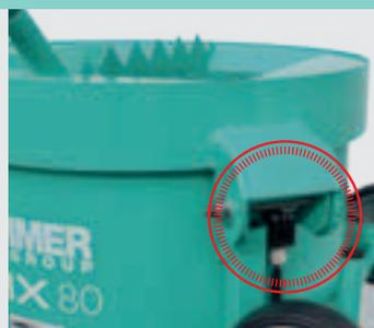
Un dispositivo elettrico blocca la rotazione delle pale di mescolamento in modo automatico quando viene alzata la griglia I-DUST. Il dispositivo agisce nella cerniera di apertura ed è posizionato in un punto protetto da urti e dallo sporco.
