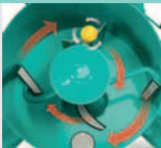
La particolare geometria delle pale di mescolamento ed il satellite rotazionale consentono di ottenere impasti omogenei in tempi brevi anche con materiali particolarmente gravosi. Fondo in acciaio a doppio spessore per limitare le usure dovute a materiali particolarmente abrasivi.
