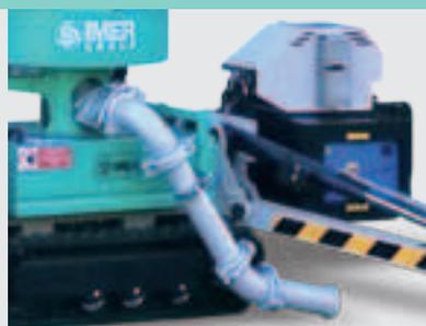
Collettore di collegamento tubazioni portamateriale DN 100 (4"), facilmente rimovibile per la movimentazione della macchina.
