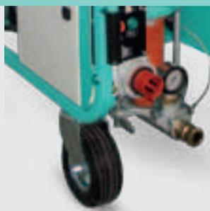
Flangia di mandata materiale in ghisa con misuratore di pressione. Connessione diretta per tubo DN35 F. Permette di estendere le tubazioni fino a 30 m con il minimo incremento delle pressioni di lavoro. La riduzione per applicare il tubo DN 25 è inclusa nell'equipaggiamento di serie.
