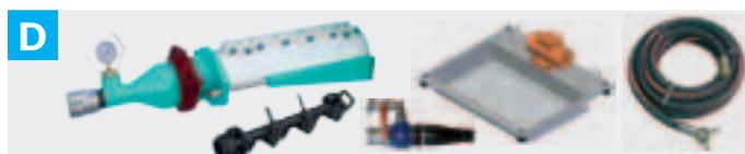
Prestazioni: portate elevate 8 mc/h, pressione 15 bar, granulometria massima 12 mm, distanza fino a 60 m, altezza 30 m.
