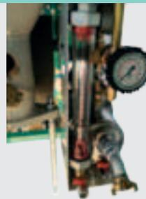
Impianto idraulico in ottone anti-ossidazione. Disposizione dei componenti studiata per migliorare il drenaggio dell'acqua nei periodi invernali. Elettropompa autoadescante maggiorata ING X3, capace di 4,5 bar di pressione e portata fino a 2500 l/h, con calotta in acciaio inox e girante in ottone.
