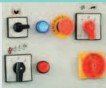
Quadro elettrico essenziale con selettore manuale del senso di marcia, selettore doppia velocità della vite eccentrica e luce di avviso griglia mancante e presenza linea alimentazione.
