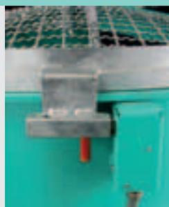
Un dispositivo di sicurezza blocca l'apertura della griglia. All'occorrenza la griglia può essere aperta sbloccando il dispositivo di sicurezza che automaticamente ferma la rotazione delle pale. Quando viene richiusa, la macchina deve essere avviata nuovamente, come previsto dalle normative.
